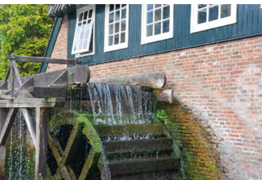
Restaurant De Watermolen in Velp. Het water valt van boven op het rad waardoor deze in beweging komt. Dit noemen we een bovenslagrad.
